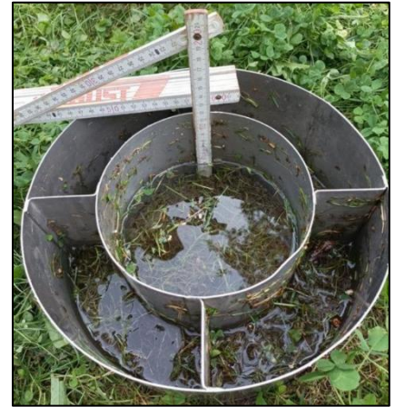
Abbildung 7 Messung mit einem Doppelringinfiltrometer (Foto © Leonie Müller)
